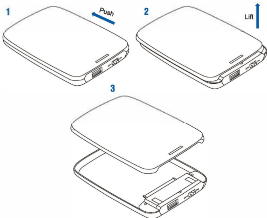
B. Befolgen Sie beim Einsetzen der 2,5-Zoll-Festplatte die Pfeilrichtung unten und schieben Sie die Festplatte dann in die angegebene Richtung vorwärts, um eine Verbindung zur SATA-Schnittstelle des Gehäuses herzustellen.
