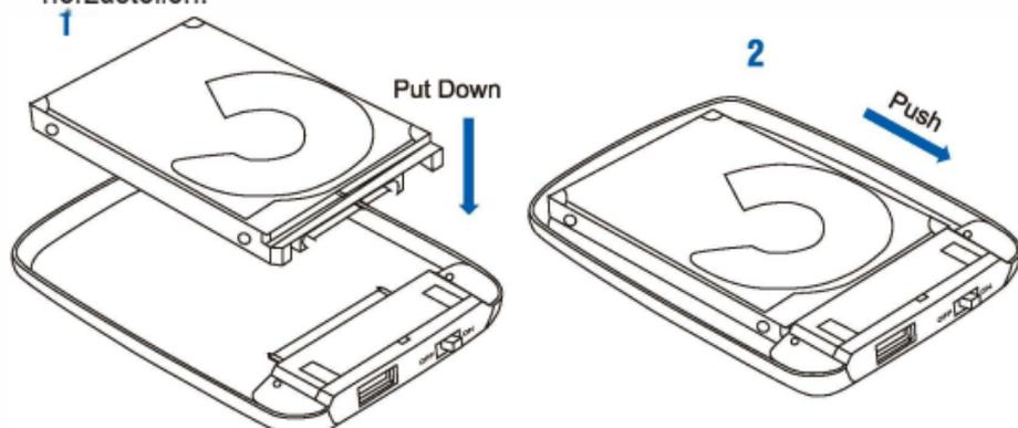
C. Richten Sie die Abdeckung wieder aus und senken Sie sie, ausgerichtet an der Position der Clip Aussparungen, ab. Bewegen Sie die Abdeckung in die angegebene Richtung, um das Gehäuse zu schließen. Die Installation ist nun abgeschlossen.
