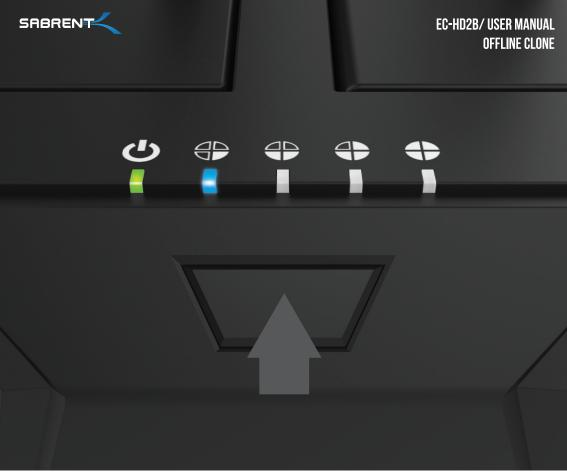
NOTE: THE OFFLINE CLONE OPERATION WILL START WHEN A BLUE LED IN THE STATUS LED INDICATOR BEGINS TO FLASH
