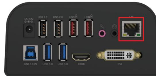
**Note:** Si vous ne pouvez pas vous connecter au réseau, éteindre le routeur et le modem pendant 30 secondes, puis à nouveau avec le câble réseau connecté à la station **Sabrent**.
